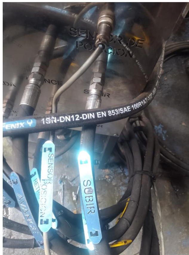
Figura 3. Marcación de mangueras por línea.
