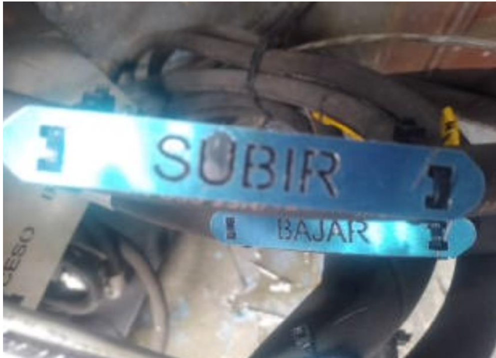
Figura 3. Marcación de mangueras por línea.
