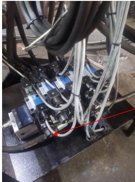
Figura 6. Venteo verificación de presión en el sistema hidráulico.
