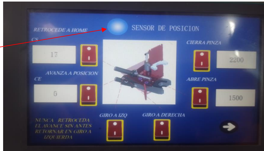
Figura 9. Verificación SENSOR DE HOME
