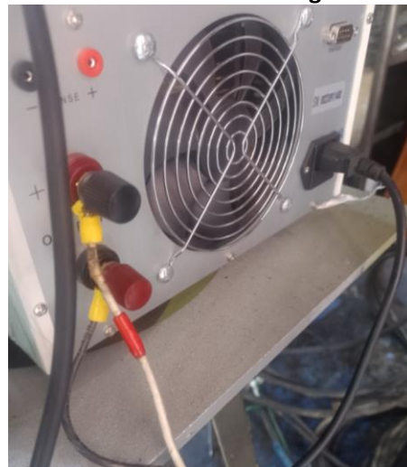
Figura 7. Cable de Alimentación, con banda roja cable señal positiva, cable negro señal negativa.
