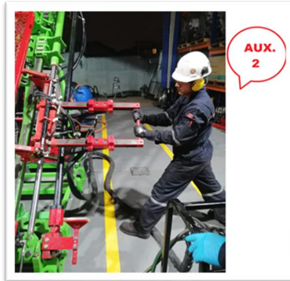
Imagen 7 Rod handler en columna de perforación
